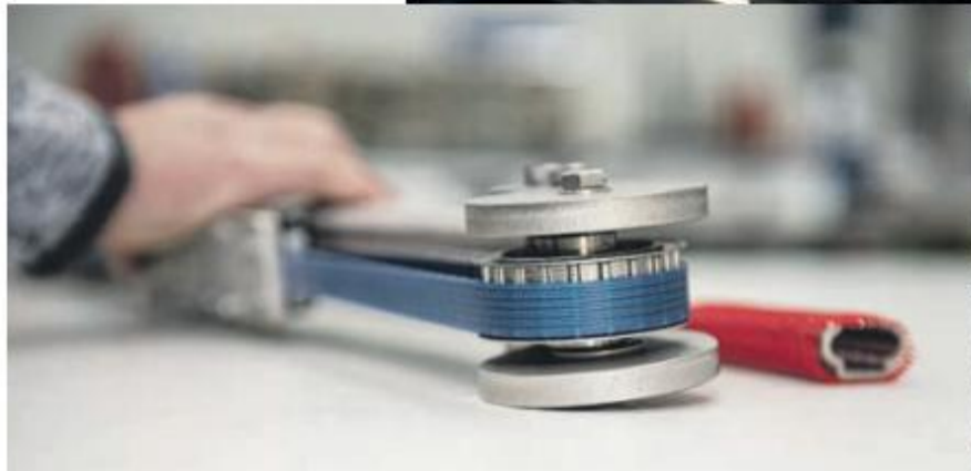
Montage van een rvs geleiding. Let op de blauwe tandriem, waarvan slijtdelen goed zichtbaar zijn bij visuele en camera-inspectie.
